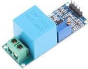
Figura 4: Módulo sensor de tensão alternada ZMPT101B
