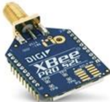
Figura 2: Módulo XBee S2C-PRO
